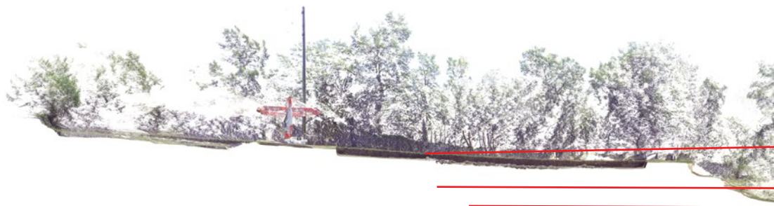
Slika 19. Gardun (antički Tilurium), presjek sonde D dobiven na osnovi 3D skeniranja 2014. godine s ucrtanim visinama hodne površine SJ 58, temeljne stope SJ 4 i hodne površine SJ 94.
