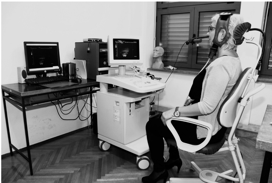
Slika 1. Ultrazvučni sustav sa stabilizacijskim sustavom ispitanika (SOS – sustav osnovne stabilizacije) i stabilizacijskim sustavom sonde (FILIP – fonetski imobilizator za laboratorijsko istraživanje proizvodnje govora)
