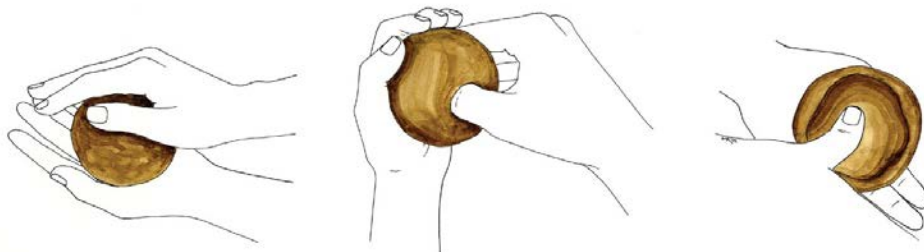
Slika 3 – Tehnika izvlačenja oblika posude iz grude gline. Fig. 3 – Technique of pinching a vessel shape from a lump of clay
