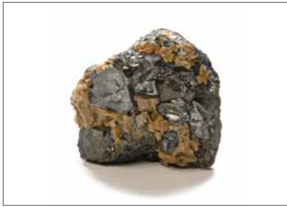
Slika / Figure 3. Tetraedrit sa sideritom, Maškara, Gornji Vakuf, BiH / Tetraedrite with siderite, Maškara, Gornji Vakuf, B&H (prema / after: Operta 2009).
